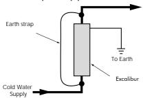
WHEN PLASTIC PIPES ARE USED BE SURE TO BOND THE ACTUAL EXCALIBUR TO EARTH
